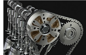
1.352 cm 3 Reihenvierzylinder mit variable Ventilsteuerung
